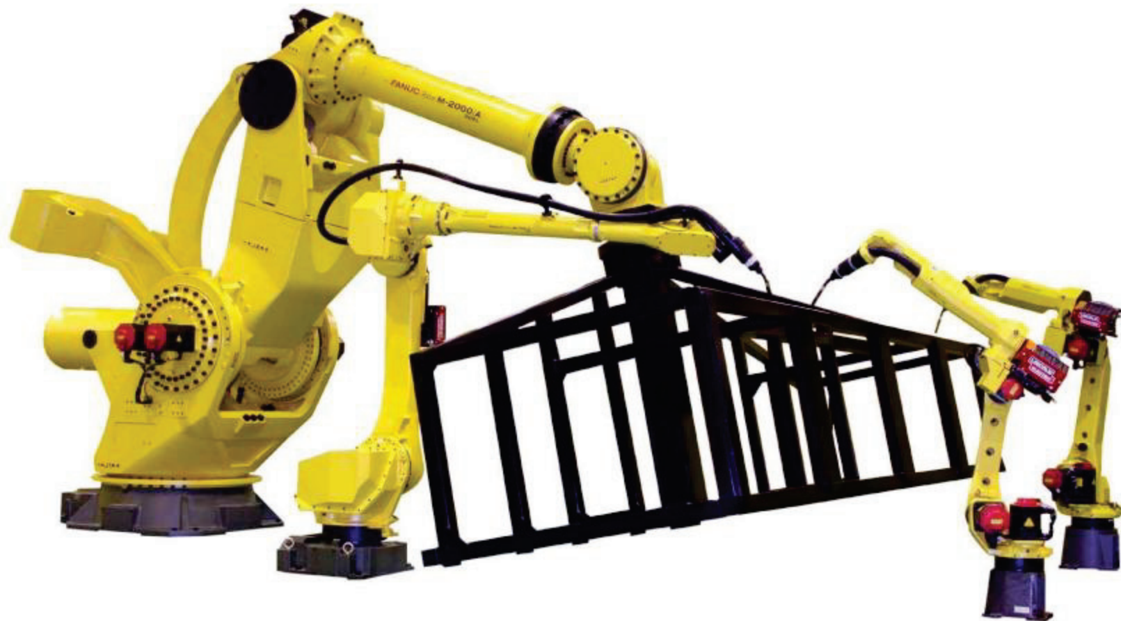
大型钢结构工件的协调焊接
